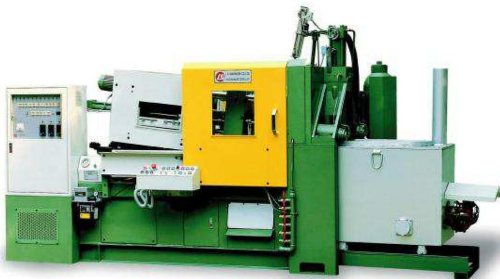
Figura 1 – Equipamento de injeção de Zamac
